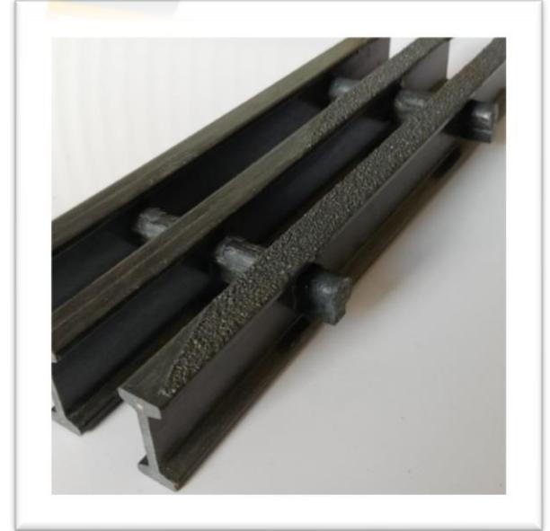
La Rejilla Pultruida REJIGLASS® se fabrica mediante avanzados procesos de pultrusión utilizando resinas isoftálicas premium y resinas viniléster de última generación, además de estar reforzada con filamentos de fibra de vidrio. Su composición de polímero es del 70% de vidrio y 30% de resina, lo que le confiere una gran dureza y destacada resistencia mecánica en una sola dirección.
